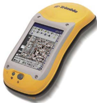
Рисунок 43. Пример мобильного устройства с ГИС приложением
