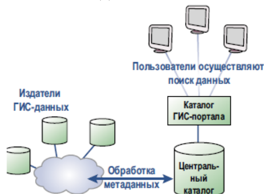
Рисунок 36. ГИС-данные и сервисы документируются в виде каталожных записей в каталоге ГИС-портала, по которому можно проводить поиск кандидатов для использования в разных ГИС-приложениях
